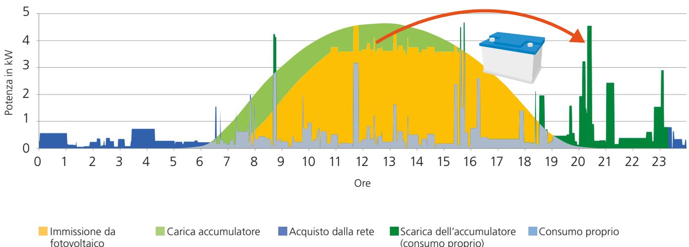
Diagramma giornaliero schematico per la produzione e il consumo con un impianto fotovoltaico, batteria compresa (fonte: Basler & Hofmann AG)
