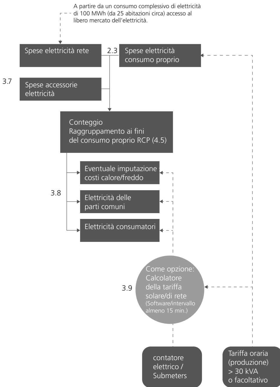
Il diagramma mostra che i punti di misura influiscono sui diversi conteggi dei costi. Qui, ad esempio, i contatori dell'acqua calda sono determinanti sia per il conteggio dei costi del calore che per quello dei costi idrici. È pertanto importante armonizzare tra loro conteggio delle spese per l'energia e
