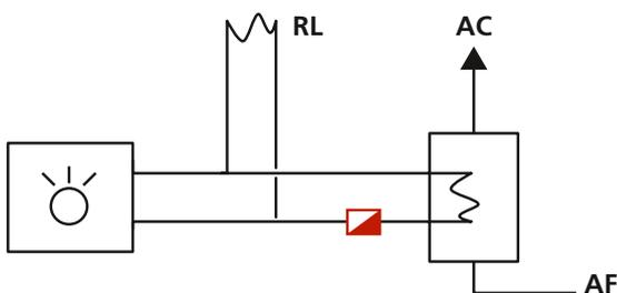
Non è obbligatorio misurare preriscaldatori e post-riscaldatori delle fonti energetiche alternative (es. energia dei collettori solari o d'impianti per il recupero di calore), salvo il caso in cui l'energia venga fatturata o accreditata ad almeno una parte delle unità d'uso. Di norma l'installazione di contatori di calore serve a titolo informativo e consente di controllare la validità dei sistemi.
