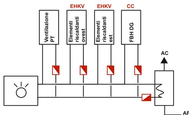
Se si collegano nuovi circuiti di riscaldamento a un sistema di ripartizione del calore già esistente, il gruppo di utenze e il sottogruppo dovranno essere provvisti di un contatore di calore che permetta di tenere conto dei diversi sistemi di misurazione mediante il conteggio di differenze.
